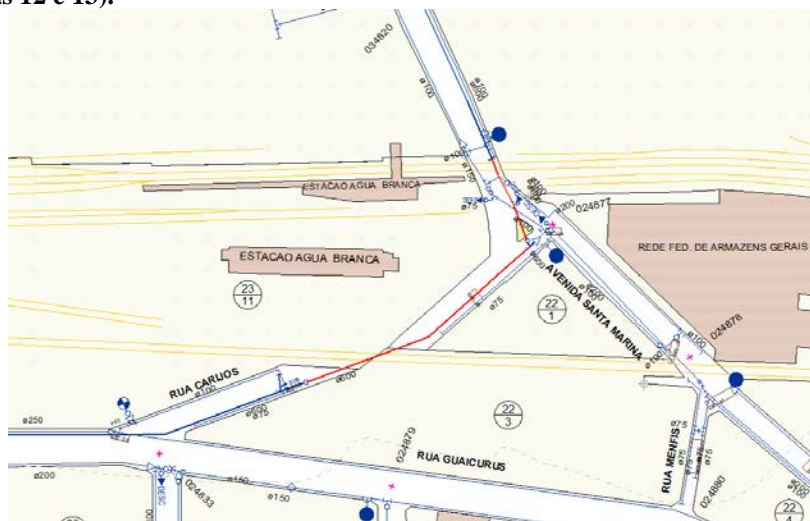
Figura 12: proposta de travessia sob trilhos da CPTM – Rua Carijós, São Paulo. (Fonte: Sabesp/MCEA)
