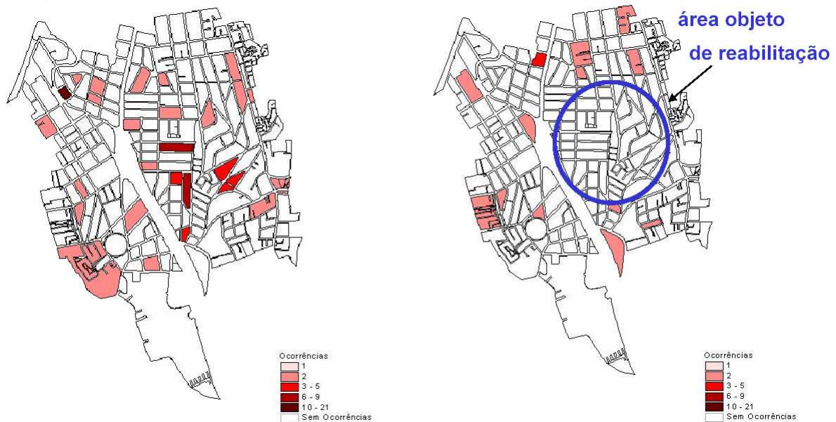
Figura 15: Reclamações de qualidade da água antes e depois da reabilitação de rede – Setor Sacomã. (Fonte: Sabesp/MCEA)
